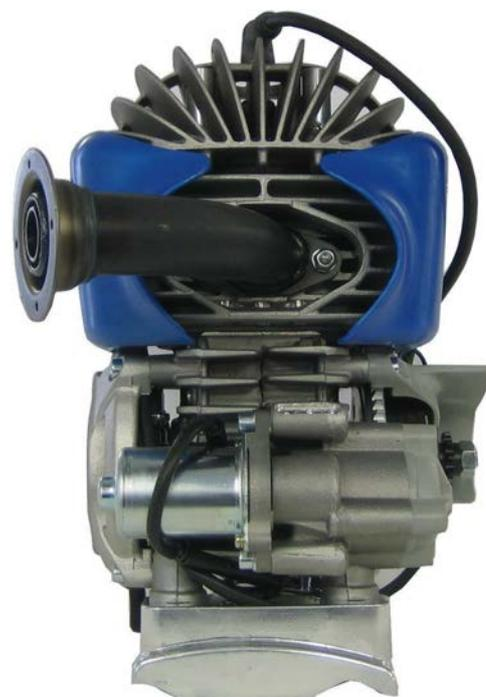
I CONVOGLIATORI DELL'ARIA POSSONO ESSERE MODIFICATI SIA PER AGEVOLARE IL GOMITO DEL PILOTA , SIA PER LO SMONTAGGIO DELL'ACCENSIONE E/O DELLA TESTA DEL MOTORE IN CASO DI VERIFICHE TECNICHE
