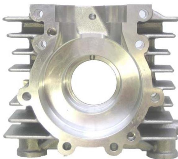
**DISTANZA MINIMA DEL PIANO APPOGGIO CARBURATORE DALL'ASSE DEL CILINDRO**
