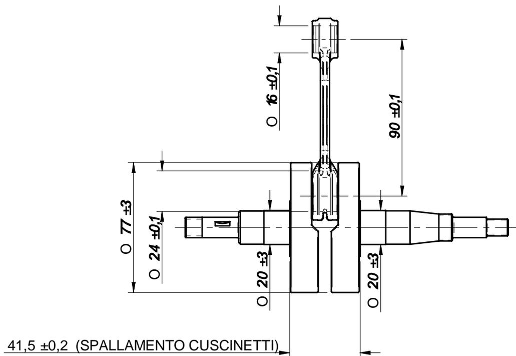
**FOTO DELL'ALBERO MOTORE EVIDENZIANDO MASSE PER EQUILIBRATURA**
