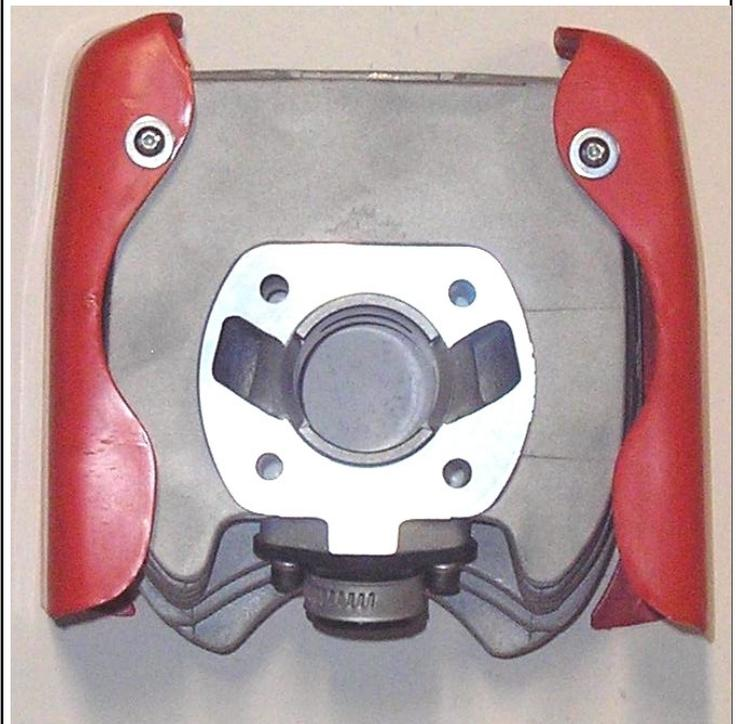
**Vecchio Sistema Disegno travasi e raccordo impulso pompa benzina**
