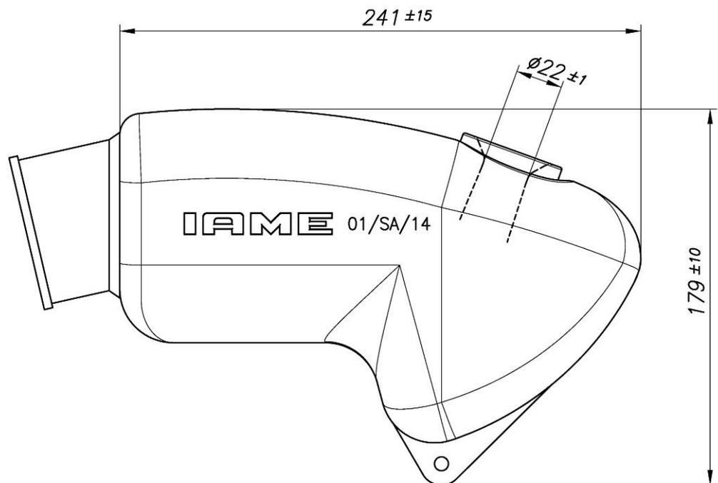
Volume interno del silenziatore verificabile con canotto entrata montato = 1760cm<sup>3</sup> ±5%
